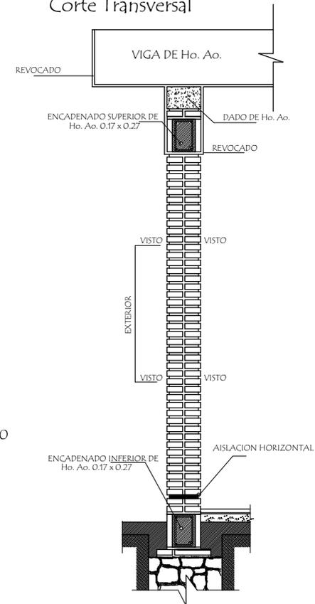
1.- EN LOS CASOS DE QUE EL AULA SEA CONSTRUIDA COMO ULTIMA DEL BLOQUE LA PARED EXTERIOR LLEVARA LOS LADRILLOS CON JUNTAS A LA VISTA HASTA LA ALTURA DE TECHO, LA VIGA Y EL DADO DE Ho. Ao. SERAN REVOCADOS.
