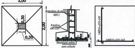
DETALLE DE ZAPATA - 140x140(Z6-Z10)
