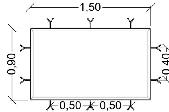
Marco para rejilla con planchuela de 1.5" 1/4 de espesor separación 1.5 pulgadas entre sí. Con anclajes de varilla en "Y" soldado al marco
